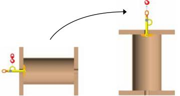
\* TIP UP REEL FROM A ROLLING POSITION TO AN UPRIGHT POSITION, PAY OUT REEL IN UPRIGHT POSITION PART NUMBER 12782 & 13037
